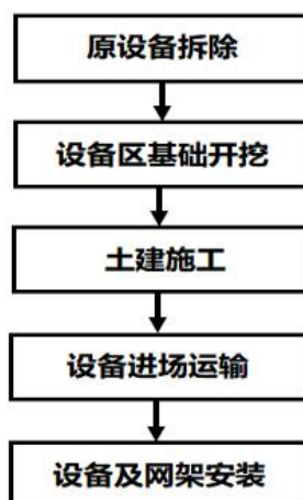
图 2-3 变电站更换工程施工工艺流程
