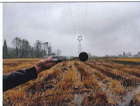
110kV 蒿裕陈线-T 陈线#25~#26 杆塔间声环境 衰减断面
