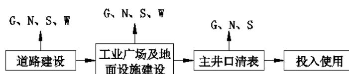
图 4-1 施工期工艺流程及产污节点图
