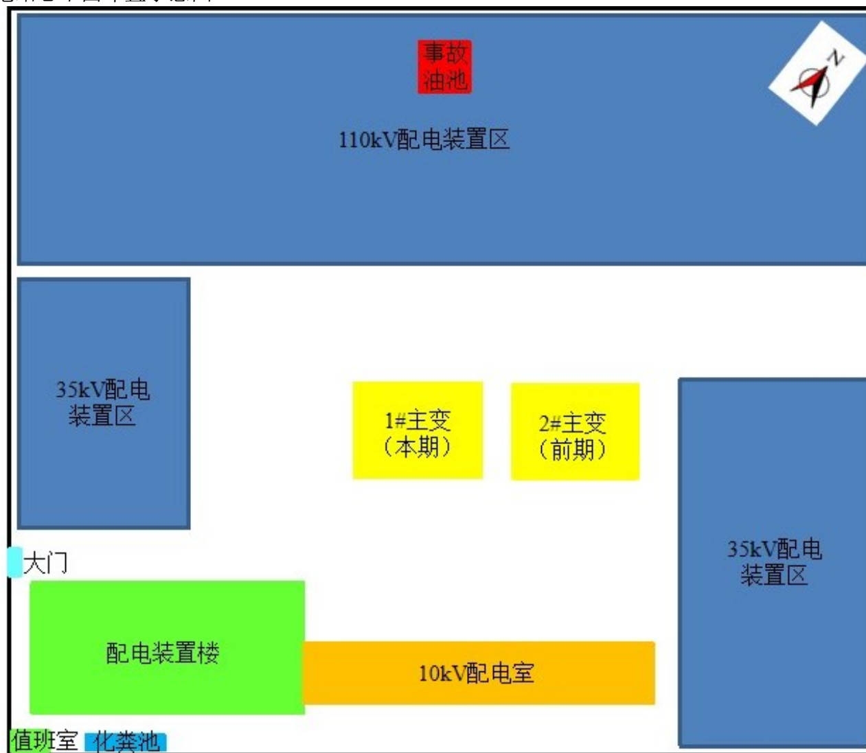
附图 2：浦市 110kV 变电站总平面布置示意图
