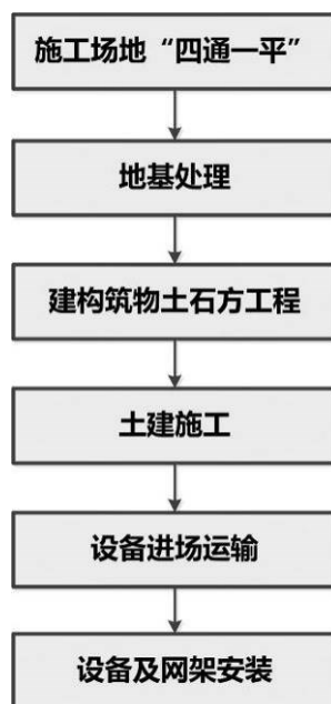
图1 变电站工程施工工艺流程
